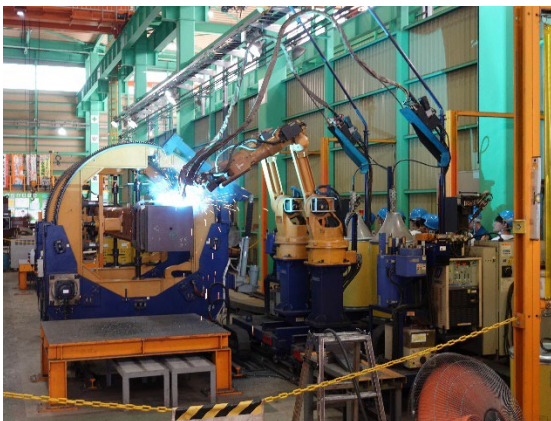
溶接ロボット
