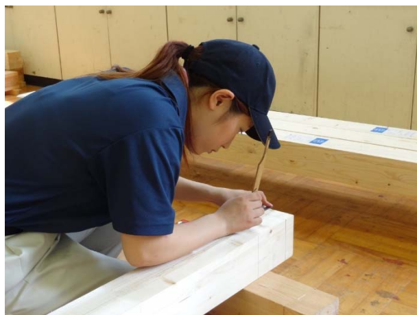
図2 継手・仕口の墨付け
