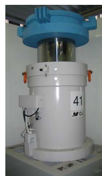
工場で使用されている 油圧ジャッキ
